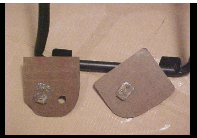
NOTE ANGLE OF CLIPS: DETERMINE ANGLE BY FITTING SEATBACK COVER OVER FOAM, INSTALL BOARDS, MARK POSITION OF RECEIVER SLOTS ON FRAMES. TAKE YOUR TIME! RIVET CLIPS ONTO BOARDS.
