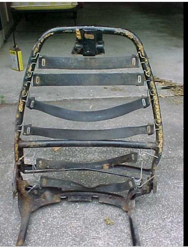
**WE NOW** PREPARE THE FRAMES FOR NEW FOAM/COVERS. REMOVE THE WEBBING, WIRE BRUSH THE FRAMES, RUST TREAT (NAVAL JELLY), PRIME AND PAINT THE SEAT FRAMES.
