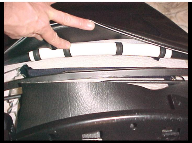
NOW THE SEATBACK COVER FLAP CAN BE PULLED TIGHTLY DOWN AND CLIPPED TO THE TUBULAR CROSS MEMBER OF THE SEAT BACK FRAME. SMOOTHE THE COVER ONCE AGAIN ON THE FACE SIDE...
