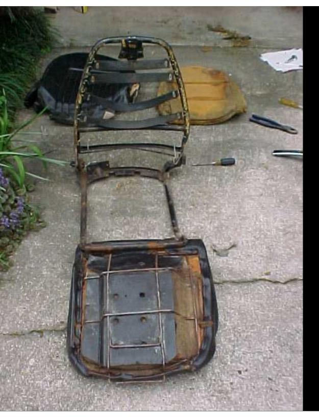
**NOW THE BOTTOM IS HELD** TO THE FRAME BY THE HINGES SHOWN EARLIER. RE-FITTING IS A REVERSAL OF THE REMOVAL! NOW, JUST PULL THE BOTTOM OFF THE CAGE FRAME.
