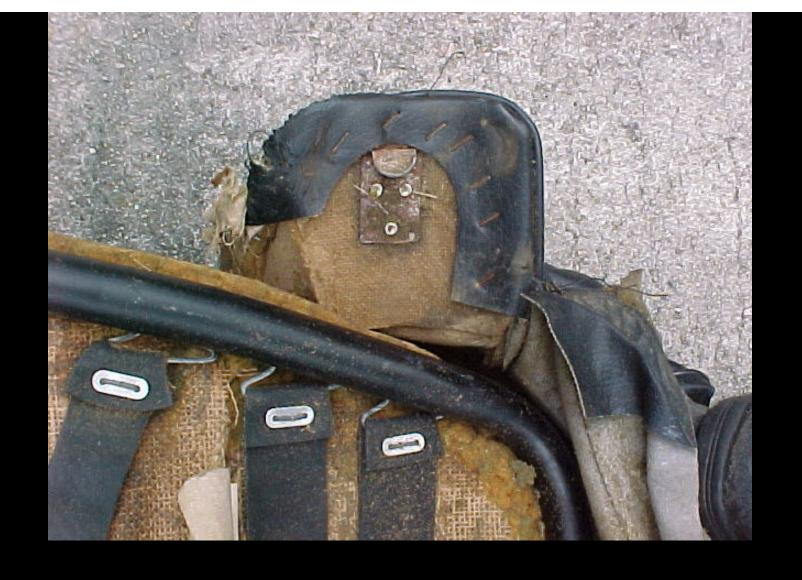
FIBER BOARD PANELS HOLD DOWN SEAT BACK SIDES TO LOWER FRAME. THESE WILL BE HOMEMADE IN THE PROCESS.
